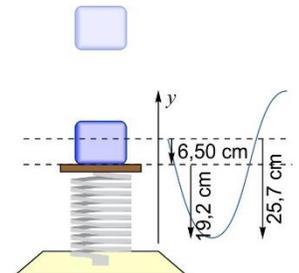
L'amplitude du mouvement est de 19,2 cm (la seconde solution de l'inverse tangente aurait donné  $-0,192 \text{ m}$ , donc invalide mais de même valeur). La masse comprimera donc le ressort de 19,2 cm sous la position d'équilibre, qui se trouve déjà 6,50 cm sous la position initiale de la plateforme (position initiale de l'extrémité du ressort). La figure ci-haut illustre les distances impliquées. La compression totale maximale est donc :
