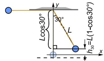
La vitesse du pendule, tangente à la trajectoire circulaire, est orientée à  $30^\circ$  au-dessus de l'horizontale. Ses composantes sont donc :
