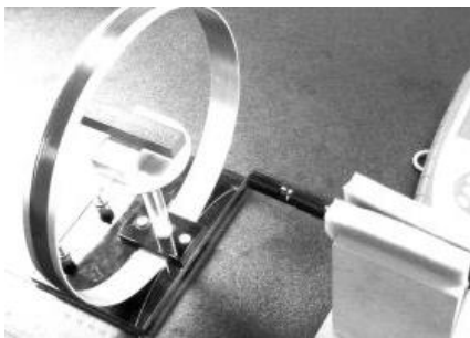
Fig. 4 : Configuration pour la mesure du champ produit par un aimant
