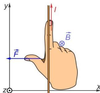
Le pouce pointe alors vers la gauche, la direction de la force magnétique sur le fil, vers  $x^-$ .
