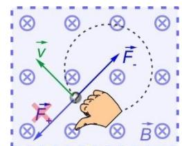
Dans cette équation, le produit vectoriel «  $\vec{v} \times \vec{B}$  » indique l'orientation de la force que subirait une charge positive. Sur le schéma, c'est la force  $\vec{F}_+$  (éliminée), qui entraînerait une déviation vers la gauche. Puisque la particule dévie plutôt vers la droite (sur son parcours), la charge est donc nécessairement négative.
