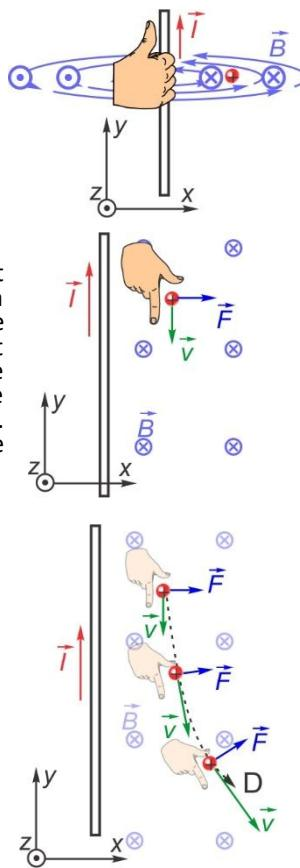
La particule se trouve donc dans un champ entrant lorsqu'elle entame sa chute. Sous l'effet de la gravité, sa vitesse sera initialement orientée vers le bas, et une force magnétique pourra donc apparaître dès le début du déplacement. Selon la RMD, une vitesse orientée vers le bas et un champ entrant entraîne sur une charge positive une force vers la droite (voir figure ci-contre). La particule devrait donc dévier vers la droite dès le début de son mouvement.
