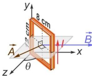
Selon la règle de la main droite et le sens du courant dans le cadre, on peut illustrer le vecteur  $\vec{A}$  l'espace (voir figure ci-contre). Le vecteur  $\vec{A}$  est en tout temps perpendiculaire au cadre et son orientation est directement liée à l'angle  $\vartheta$ .
