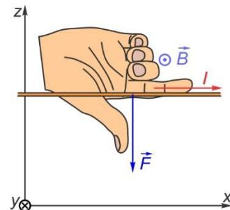
Le pouce pointe alors vers le bas, la direction de la force magnétique sur le fil, vers  $z^-$ .
