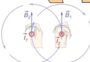
On obtient alors pour le fil de gauche une force vers la gauche et pour le fil de droite une force vers la droite... Les forces magnétiques sur les fils sont donc des forces de répulsion.
