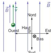
Dans l'équation du module de la force magnétique,  $\theta_{vB} = 0^\circ$ , et le sinus est nul :
