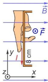
$$F_g = 1 \text{ A} \times 0,08 \text{ m} \times 1,25 \text{ T} \times \sin 90^\circ = 0,100 \text{ N}$$
