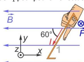
La force résultante est nulle, et c'est le cas pour tous les cas de courant dans un circuit fermé dans un champ magnétique uniforme.
