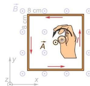
Sur le schéma, le courant tourne en sens antihoraire dans le cadre. La règle de la main droite entraîne donc un vecteur  $\vec{A}$  sortant (voir figure ci-contre).
