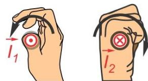
On peut alors tracer deux lignes de champ circulaire permettant de trouver l'orientation du champ magnétique à l'emplacement de chacun des fils (voir figure ci-contre). En l'occurrence, chacun des fils produit sur l'autre un champ magnétique vers le haut. On peut alors trouver l'orientation de la force sur chaque fil pour identifier une attraction ou une répulsion.
