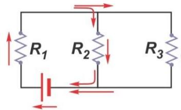
b)  $R_1$  en série avec la source et avec le groupe  $R_{23}$
