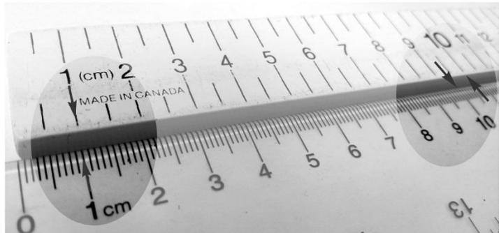
Selon le point de vue de l'appareil photo, les graduations de « 1 cm » coïncident, mais les graduations de « 10 cm » montrent un écart d'un demi-centimètre, en raison des épaisseurs différentes des règles.
