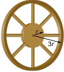
Calculez le moment d'inertie de la roue de charrette illustrée ci-contre, formée d'un disque (plein),  $m_d = 2,5$  kg, de 8 tiges (minces),  $m_t = 1,5$  kg, et d'un anneau (mince),  $m_a = 5,0$  kg. Aussi,  $r = 30$  cm.
