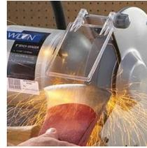
Mettre en rotation à 350 rad/s une meule circulaire de 1,25 kg requiert une énergie de 490 joules.
